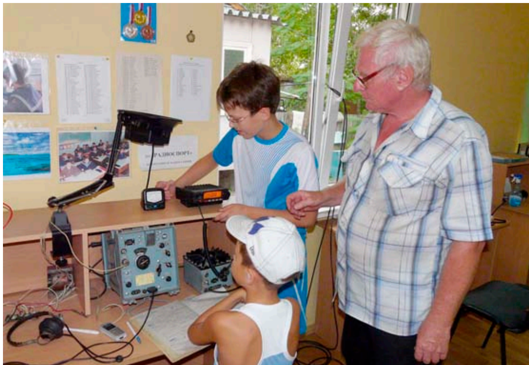
Валерий Бурьян (UA6LUN) всегда готов помочь юным радиолюбителям. Вот и на этот раз нужно настроить УКВ антенну. КСВ-метр показывает — 1,5, значит можно работать в эфире...
