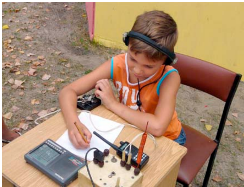
Артем тренируется принимать отдельные буквы азбуки Морзе по эфиру, используя КВ-приемник «Деген»
